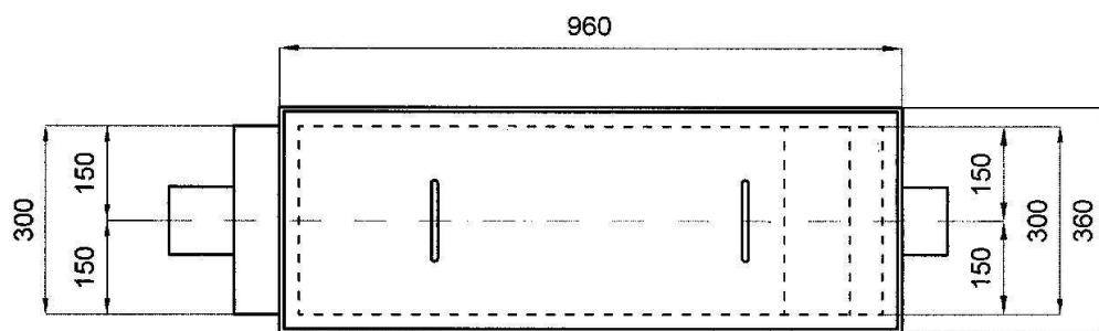
Separator služi za odvajanje benzina i ulja iz otpadnih voda. Jednostavnom konstrukcijom i funkcionalnošću separator je neophodan u garažama, mehaničarskim radionicama i sličnim objektima, gde se otplake mešaju sa tečnostima lakšim od vode. Na jedan separator možemo spojiti šest garaža za putnička vozila.
